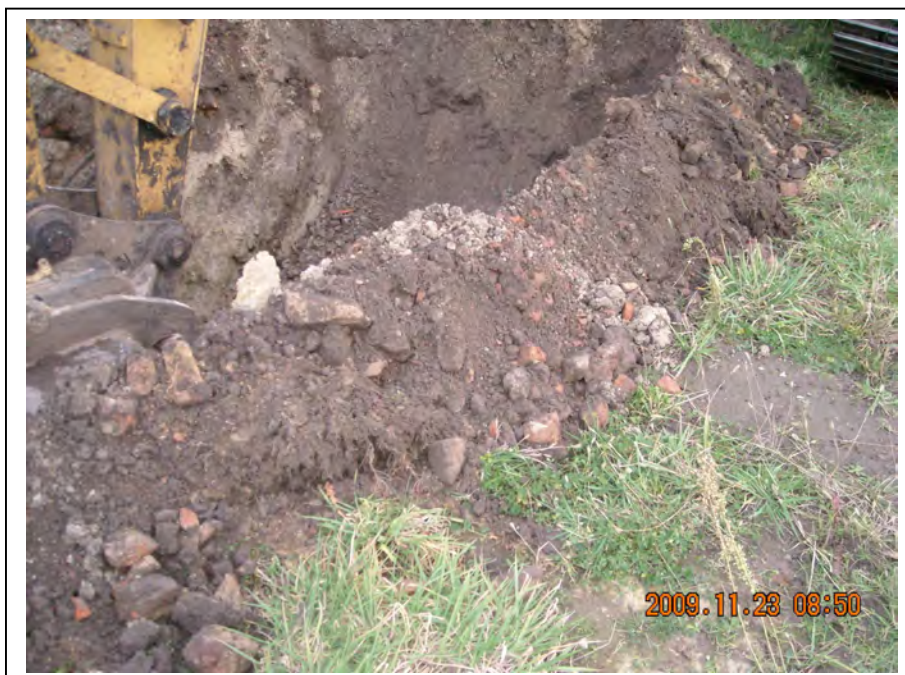
Bild 5: Schurf 5, südliche Freifläche (Auffüllung mit Bauschutteinlagerung)
