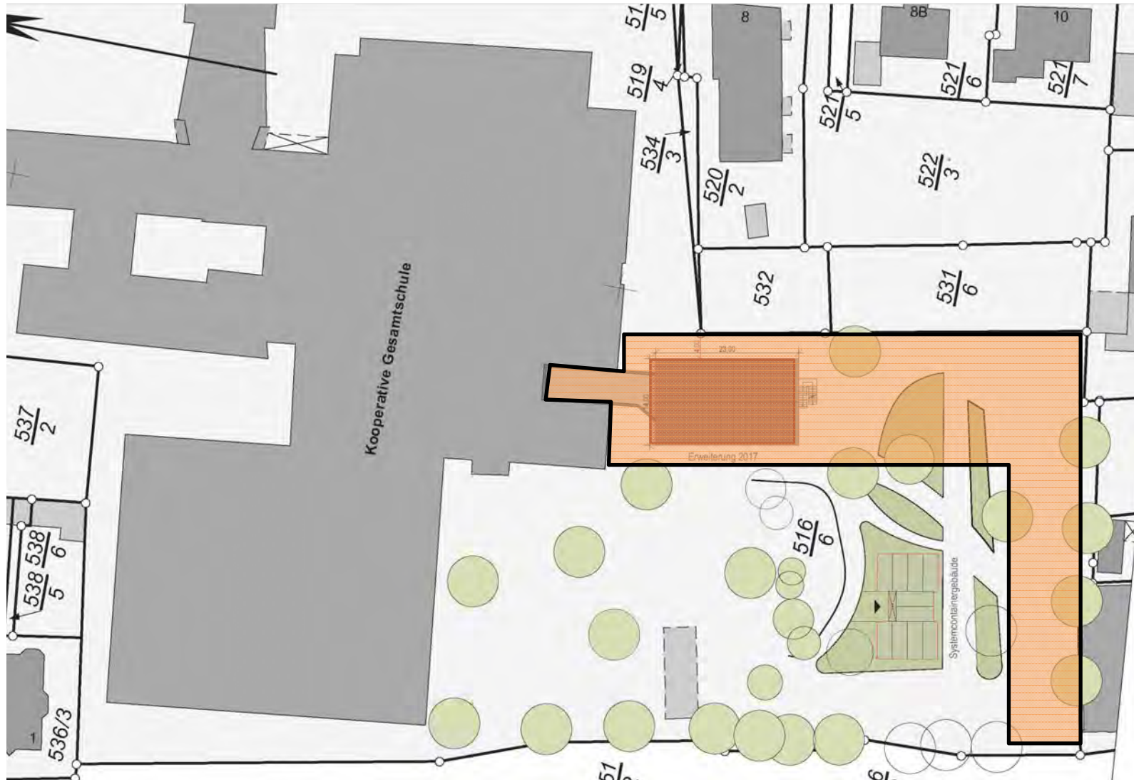
Erweiterungsbau 2017 ( Anbau Gebäudebestand, Verbindungsgang ) Baustellenlogistik Ost/Süd.
