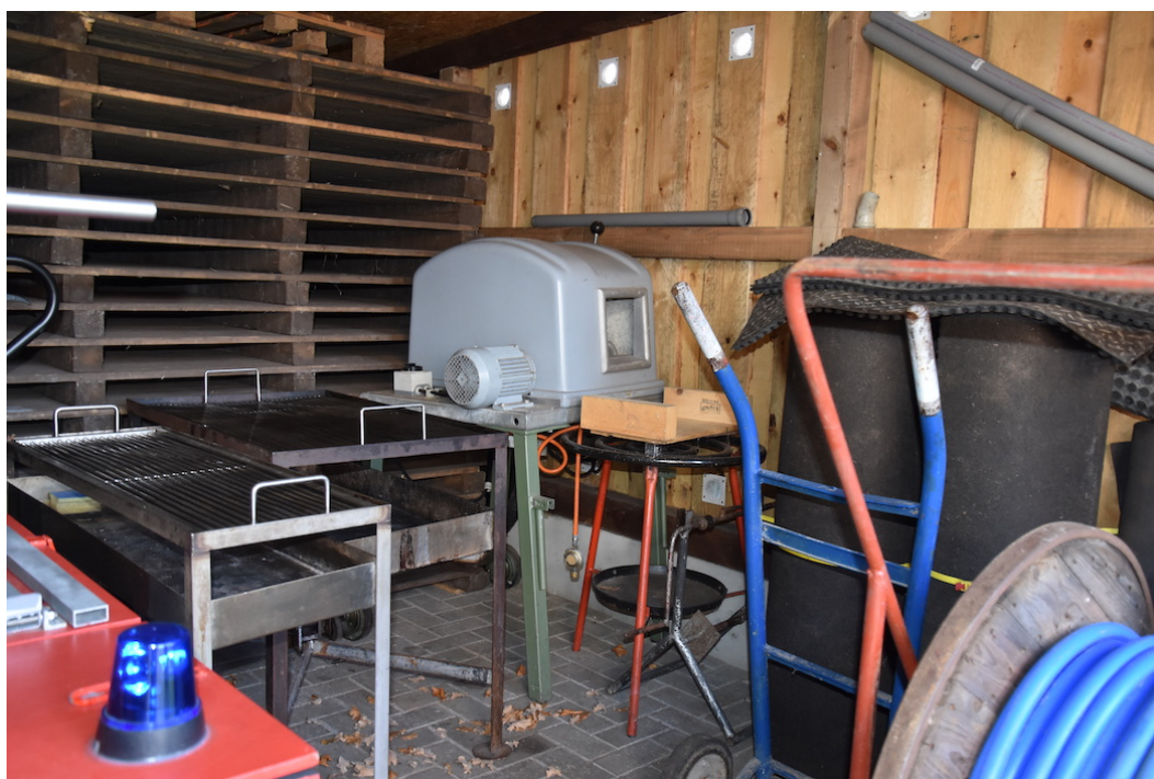
Abb. 7.3-28: OF Loy-Barghorn: Alte Schlauchwaschanlage in der Kaltgarage
