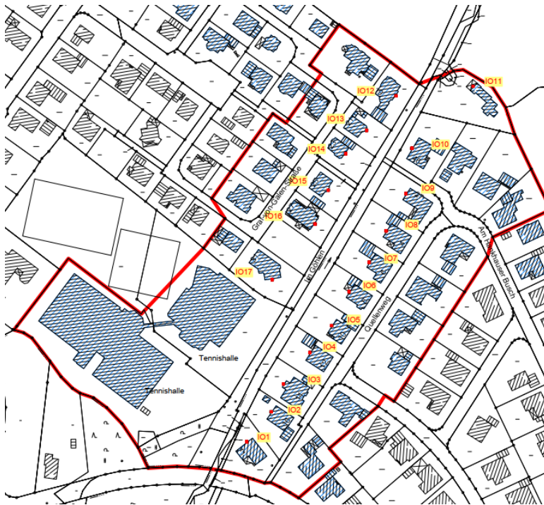
Anlage zur Prognose über die verkehrsbedingten Geräuschimmissionen: Lageplan mit Immissionsorten Abschnitt „Im Göhlen“
